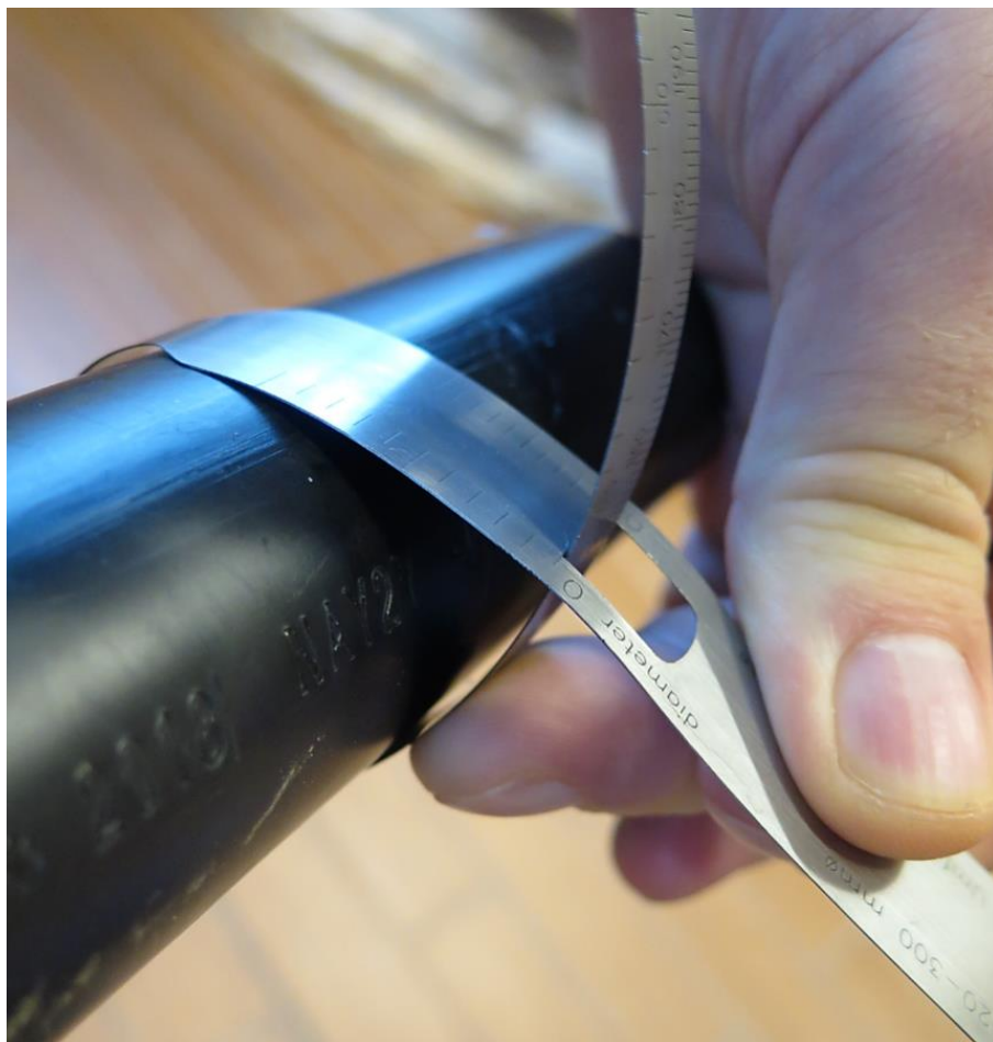
Pomiar średnicy zewnętrznej kabla przy użyciu taśmy mierniczej i suwmiarki
