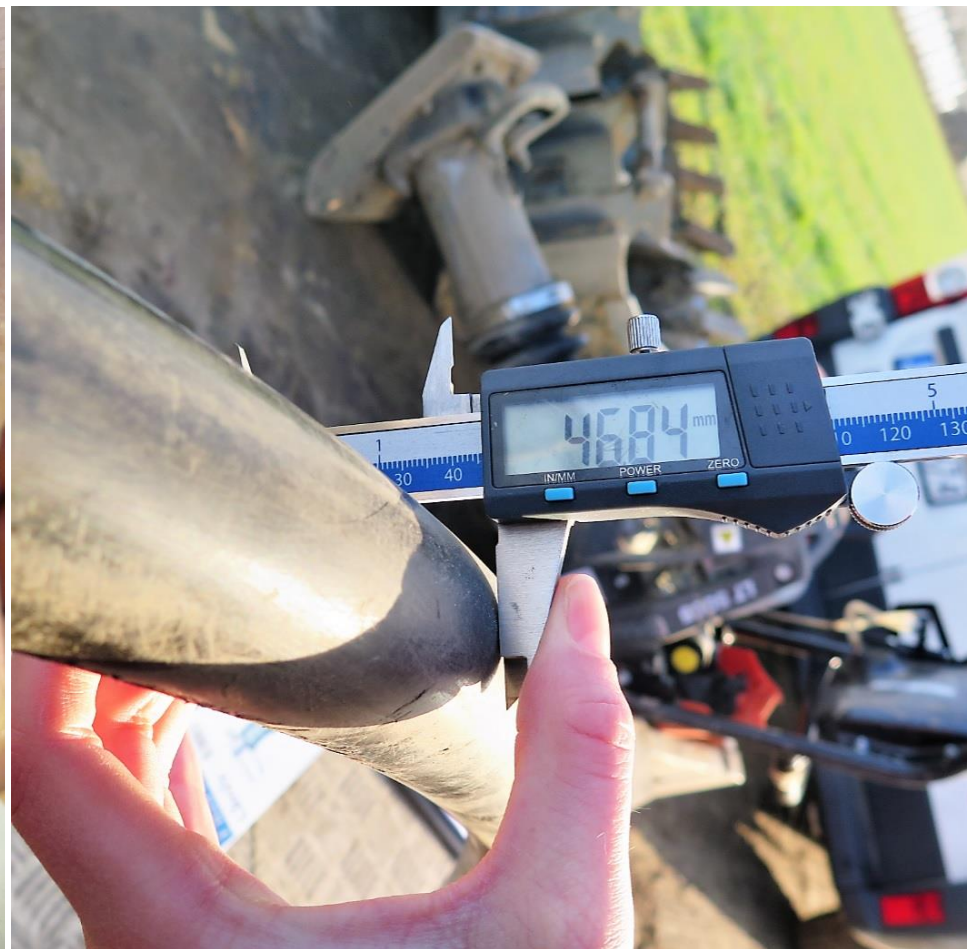
Pomiar średnicy zewnętrznej kabla przy użyciu taśmy mierniczej i suwmiarki
