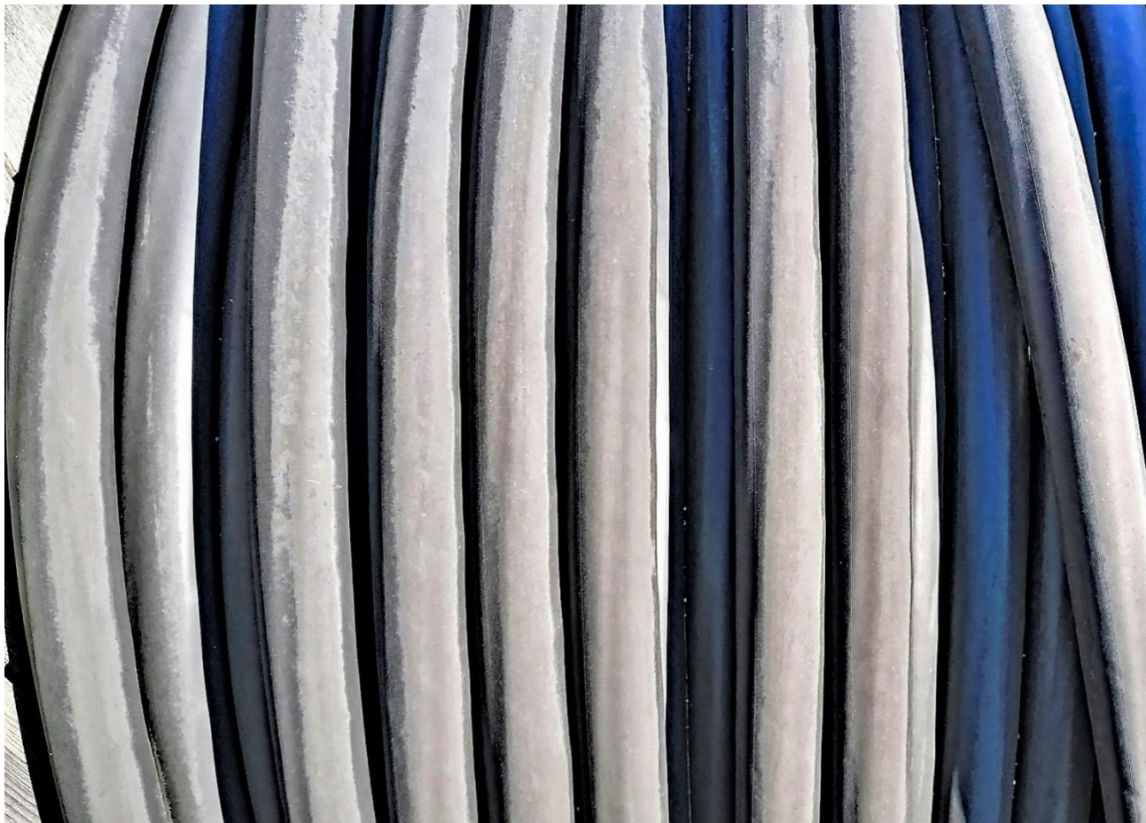
Powłoka kabla nawiniętego na bębnie transportowym wystawionym na promieniowanie UV
