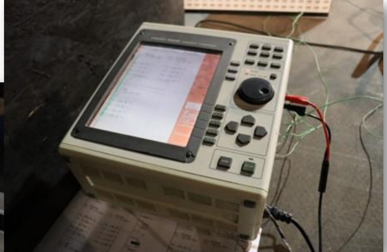
Układ pomiaru temperatury przewodów
